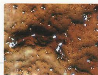
マイクロセパレータ上に 吸着したスラッジ
