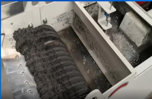
タンク内の液面が設定値に達すると、くし形のマグネットロールが回転し、吸着したスラッジを排出します。排出の際、マグネットロールは一定回転し下部(液中)は新しいマグネットの面となりスラッジの吸着を開始します。
