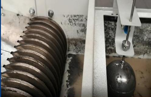
マグネットロールは円筒状ではなく、くし型のマグネットロールを採用。タンク内の液面を検知するため液面計を搭載しております。
