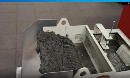
一度排出されたスラッジはカキ板上部に滞留し水切りを行います。後ろから新しく排出されたスラッジによって押し出され、スラッジBOXへ回収します。上記を繰り返しくーラント液に混入しているスラッジを効率よく回収します。
